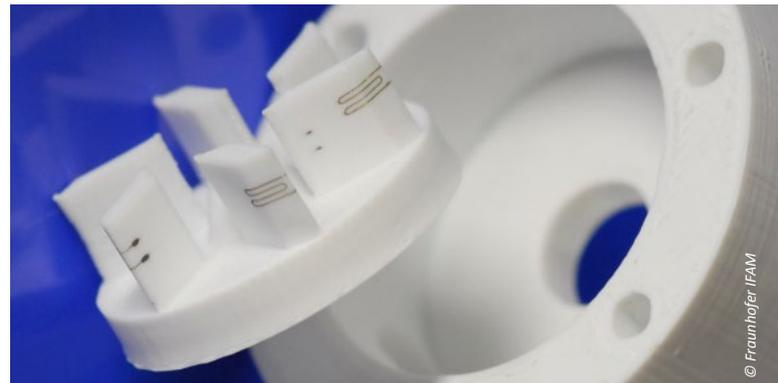
Mittels Aerosol Jet gedruckte funktionale Sensorelemente auf 3D-gedrucktem Bauteil.
