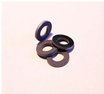
Foto von Teststrukturen aus 1 µm Carbonyl-Eisen-Partikeln, Querschnitts-Zeichnung sowie REM-Aufnahme einer fertiggestellten Teststruktur von oben. Der Außendurchmesser beträgt 6 mm.
